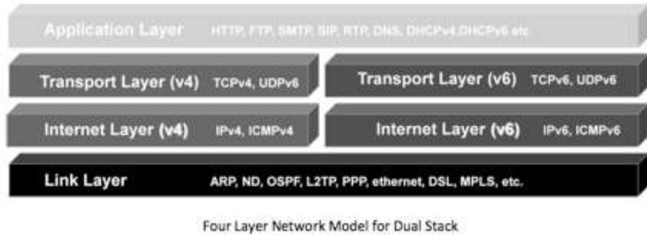
Gambar II. 27 Model Layer dalam *Dual Stack*
