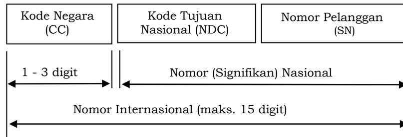
Gambar II. 1 Struktur penomoran menurut Rekomendasi ITU-T E.164
