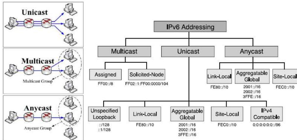
Gambar II. 26 Deskripsi *Unicast*, *Multicast*, dan *Anycast*
