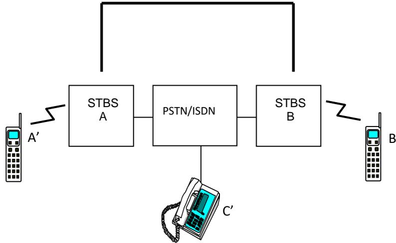
Gambar IV. 3 Konfigurasi Umum Hubungan STBS
