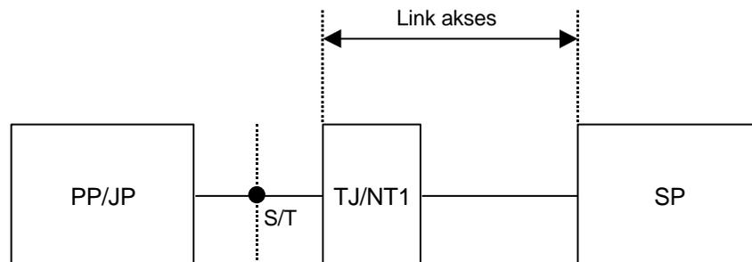
Gambar XI. 4 Konfigurasi Terminal ISDN
