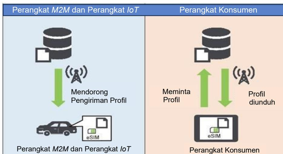
Gambar 1. Perbedaan Utama Mekanisme *Provisioning* eSIM Jarak Jauh
